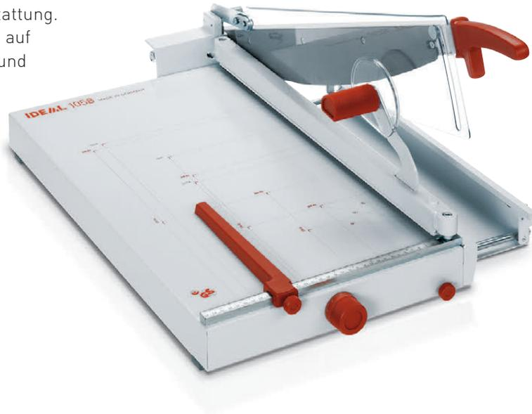
Komfortable, praktische Handhebel-Druck-Drückung. Ausfahrbarer Vorderanschlag mit Schmalschnitteinrichtung und Arretierschraube. Stabiles Messerlager aus Aluminiumguss und zweifach gelagerte Messerachse für präzise Schnitte. Bruchssichere Messerschutz-Automatik aus transparentem Kunststoff. Solide Ganzmetall-Konstruktion.
