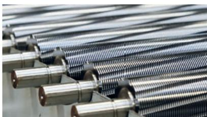
Die Schneidwellen aus gehärtetem Vollstahl mit lebenslanger Garantie sind unempfindlich gegen Heft- und Büroklammern und garantieren Langlebigkeit.
